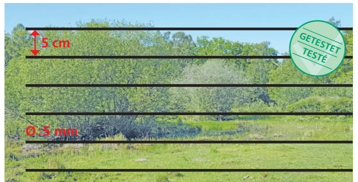
Abbildung 5: Markierungen mit vertikalen oder horizontalen schwarzen Linien sind bei transparenten Verglasungen wie Wind- oder Lärmschutzwänden, Passerellen oder Lifttürmen sehr effizient und stossen meist auf grosse Akzeptanz. Ist der Hintergrund oft eher dunkel, ist eine Ausführung mit weissen, orangen oder kristall- oder metallfarbenen Linien empfehlenswert. © Schweizerische Vogelwarte
