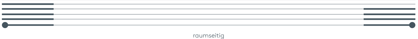
Typ-Nr. P51: 5 Läufe, 9 Paneele, 2-tlg., Paket außen
