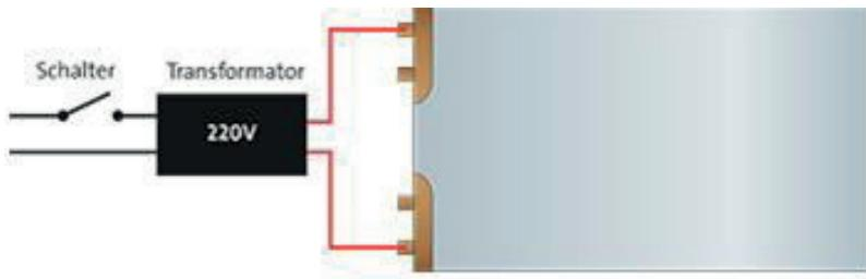
**Betriebsspannung (EIN):** 48V oder 60-65V(AC 50/60Hz) Wechselspannung
